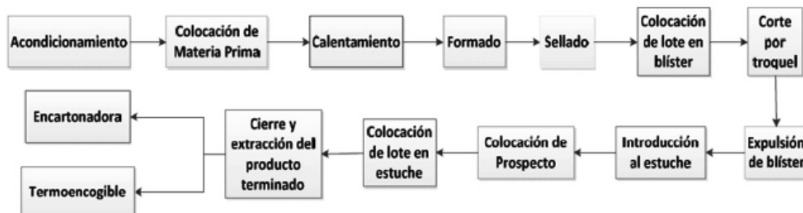
Figura 3. Proceso de empaque farmacéutico tipo blíster
