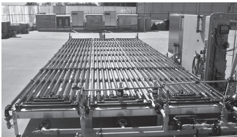
Figura 3. Sistema de cultivo cerrado. Fotorreactor tubular de configuración horizontal
