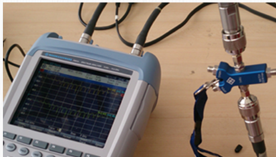
Figura 3. Proceso de calibración del analizador de espectros.
