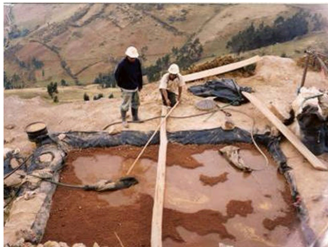
Figura 4. Proceso de cianuración de minerales para extracción del oro
