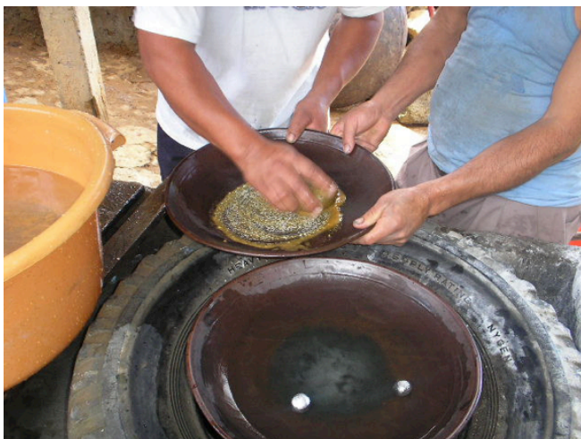
Figura 3. Proceso de amalgamado de oro con mercurio
